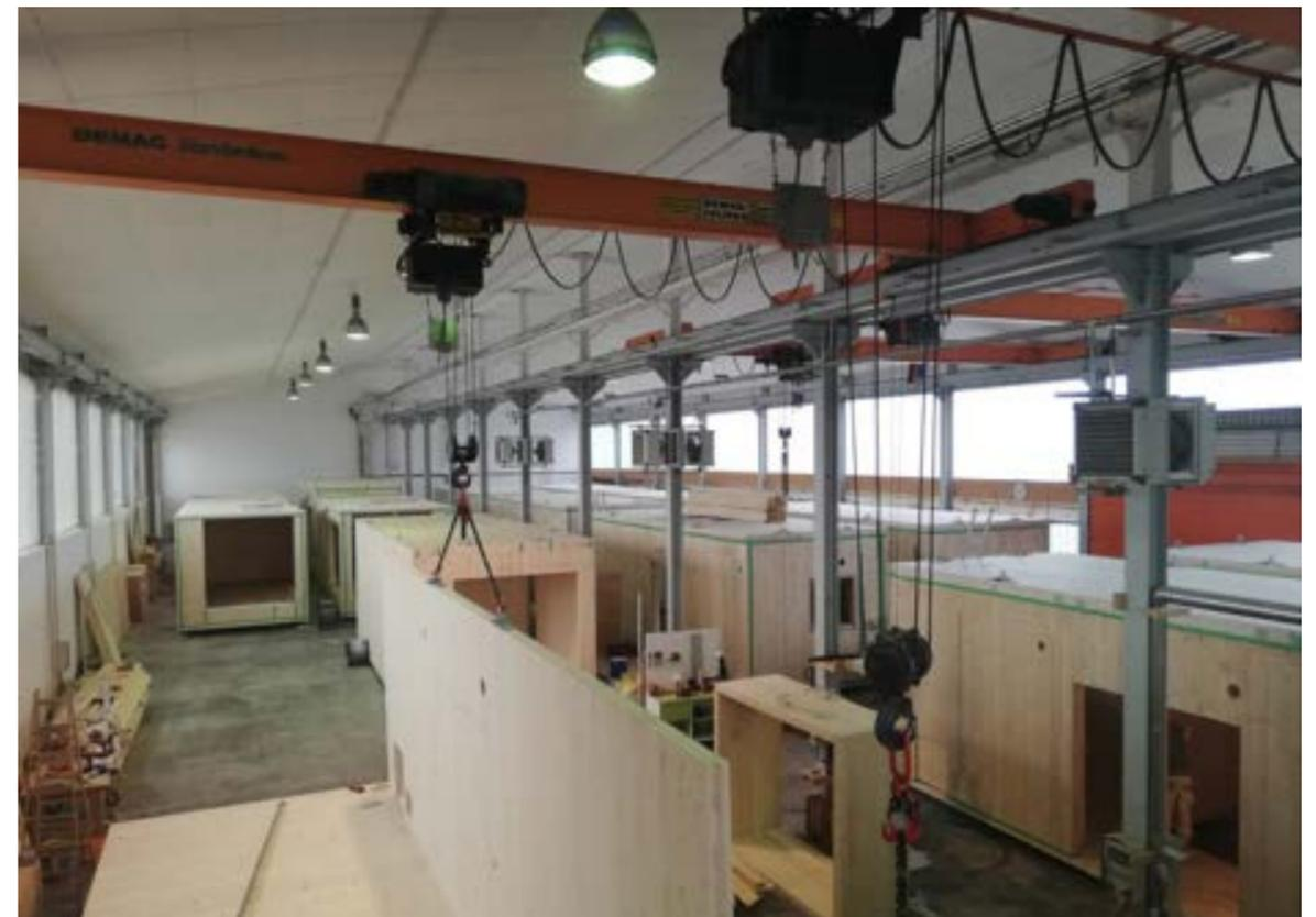
Nach der Vorfertigung der „rohen“ Holzmodule werden diese von den verschiedenen Gewerken ebenfalls seriell bearbeitet und mit der Haustechnik und der Innenausstattung versehen.
