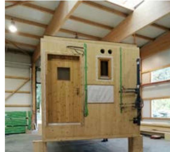
Die fertigen Module werden dann für den Transport zur Baustelle vorbereitet. Durch den Einsatz einer innovativen Bauzeitabdichtung, die aufgrund des niedrigen sd-Wertes (Dampfdiffusionswiderstand) auf den Modulen belassen werden kann entfiel die sonst übliche Verpackung der Module in Kunststoffolie für den witterungsgeschützten Transport; das Abfallaufkommen konnte dadurch weiter verringert werden.
